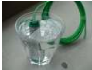
センサーは使用前に十分水に浸した状態で埋設します。
